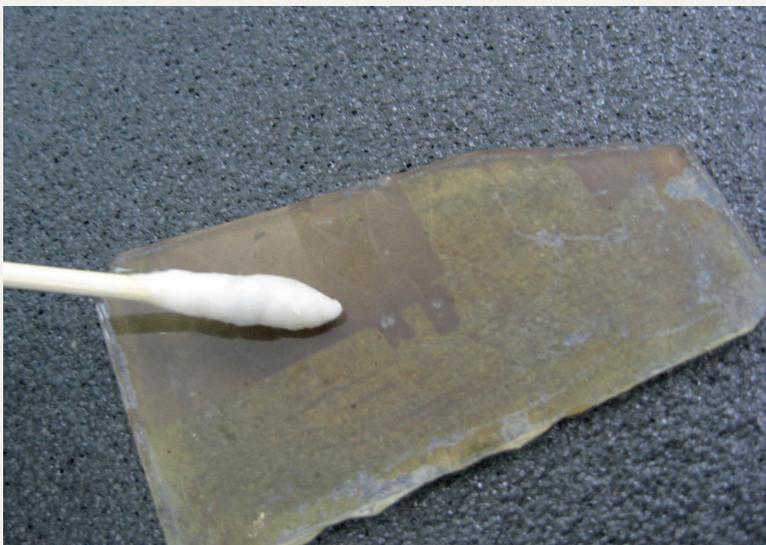
Fig. 16. Limpieza con etanol.
